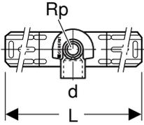
**Einzel-Armaturenanschluss-Set MeplaFix, abgesetzt**
