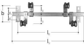
**JRG Sanipex Halterung für Verteiler 5740**
