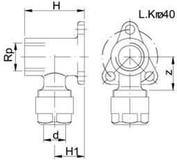
**Instaflex Armaturenanschluss einfach, mit Flansch 3032**
