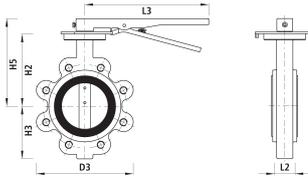
**Absperrklappe mit Handhebel Typ LT 9942**
