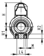
**Kugelhahn Typ 546 PVC-U mit integrierter Befestigung und Klebemuffen metrisch**
